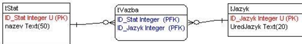
Obr. 10 Diagram dekomponované vazby M:N pro informaci o státě a jeho úředním jazyku
