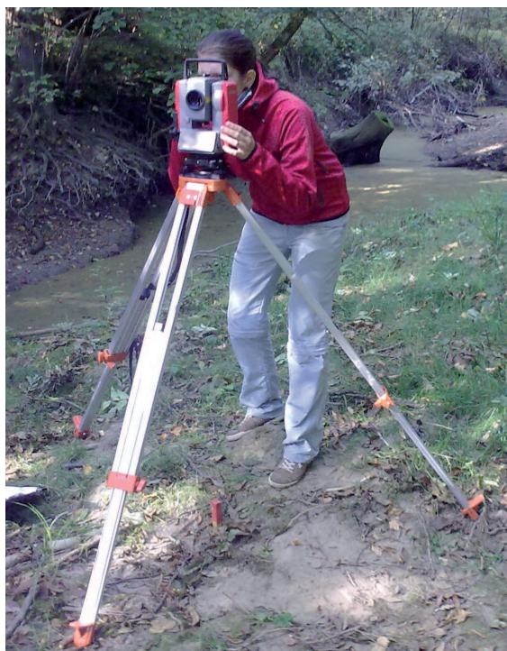
Obr. 3.8: Správně ustavený stroj, ale chybně nastavená výška přístroje
