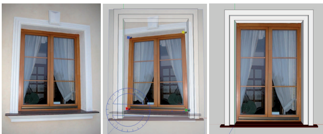
Obr. 5.23: Úprava fototextury při tvorbě okna
