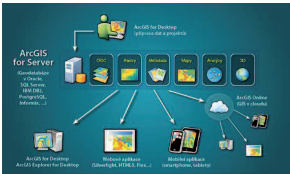
Obr. 6.4: Architektura komplexního řešení ArcGIS for Server (ArcGIS for Server 2013)
